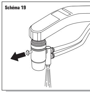
**REMARQUE:** Il faut un peu de temps pour que l'eau sature la cartouche et commence à couler de la dérivation. Laissez couler l'eau pendant 5 minutes afin d'éliminer les poches d'air et la poussière de carbone. Il faut compter entre 5 et 15 minutes pour les dégager.
