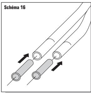
7. **Insérez** chaque tube aux endroits appropriés sur le support de fixation jusqu'à ce que vous arriviez aux traits ou que les traits disparaissent (Schémas 17 et 18).
